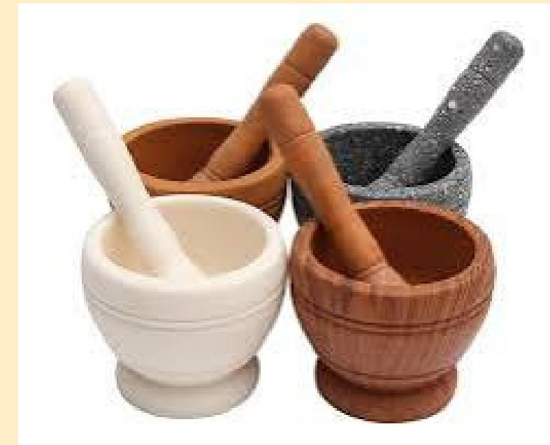
Los morteros son instrumentos de porcelana, madera o cerámica compuestos por una base y un pistilo. Su función principal es triturar, pulverizar o mezclar sólidos para obtener partículas finas, necesarias en la preparación de reactivos o en la homogenización de muestras.
